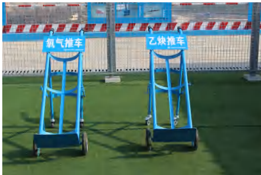
氧气、乙炔瓶推车示意图
